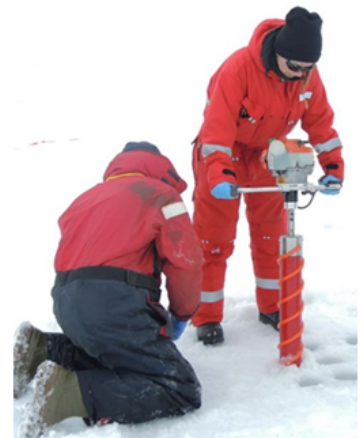
Abb.1: Eiskernbohrung (Foto: Giulia Castellani)
